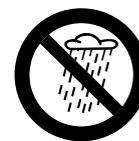
Le moteur d'entraînement n'est pas étanche. **Pour réduire le risque de court-circuit ou d'électrocution**, ne travaillez jamais avec l'outil électrique sous la pluie ou dans des endroits humides ou très humides.
