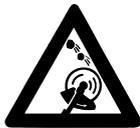
Vérifiez le chantier - des pierres, des objets métalliques, etc. pourraient être rattrapés et éjectés - potentiellement au-delà d'une distance de 15 m – **risque de blessure !** De tels objets peuvent également endommager l'outil de coupe et d'autres biens (par ex. véhicules de stationnement, fenêtres).
